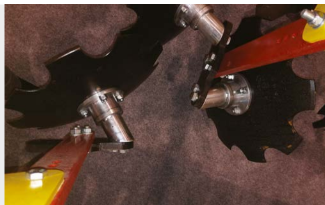
Уплотнительное кольцо + защитная металлическая крышка + уплотнение RS/ Кассетное уплотнение + защитная крышка из поковки
