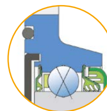
Уплотнительное кольцо + защитная металлическая крышка + уплотнение S/ Двойное трехкромочное уплотнение с усиленной шайбой
