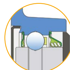
Защитная металлическая крышка + уплотнение 5/ Трехкромчатое уплотнение + защитная крышка
