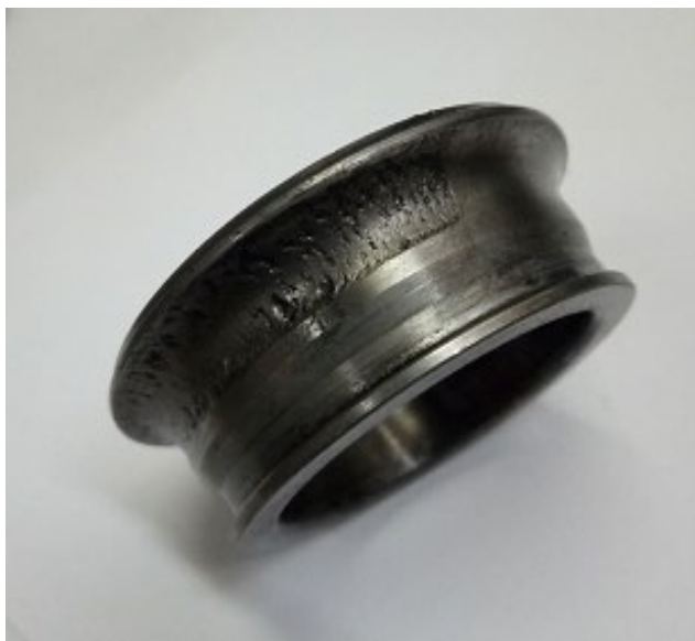
Повреждение на внутреннем кольце
