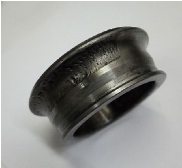
Повреждение на одном из двух внутренних колец
